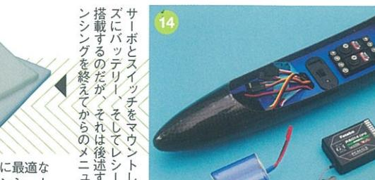
バッテリーの搭載に最適なのが低反発ウレタンシート。これで包むだけでしっかりと固定される。
