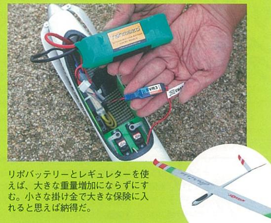
リポバッテリーとレギュレーターを使えば、大きな重量増加にならずにする。小さな掛け金で大きな保険に入れると思えば納得だ。
