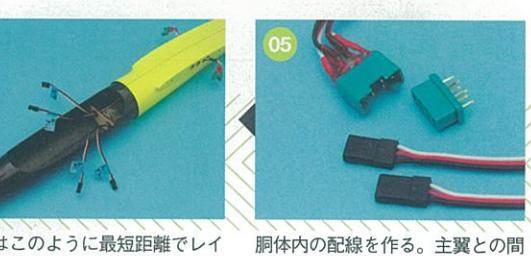
胴体内の配線を作る。主翼との間に6ピンコネクターを用い、メスを胴体側に使用する。ハンダ付けは慎重かつ確実に行う。
