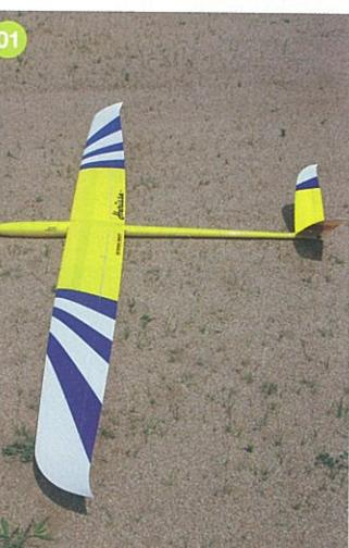
RG15という型式をベースにOK模型が独自にモディファイしたエアロフォイルがアリッサの性能を格段に上げている。
