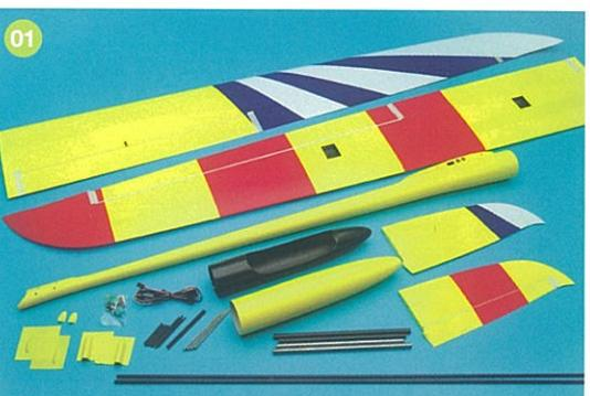
これがすべてのキット内容。製作に必要な接着剤（瞬着各種とエボキシ系樹脂30分）と工具はもちろん、キット純正のパーツに換えて使用するものに関しては個々に説明していく。
